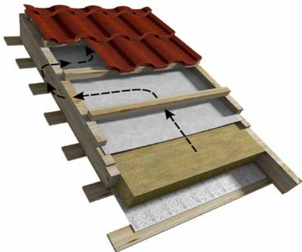
Рис. 6. Строение кровельной системы ТН-ЛЮКСАРД Мансарда.
