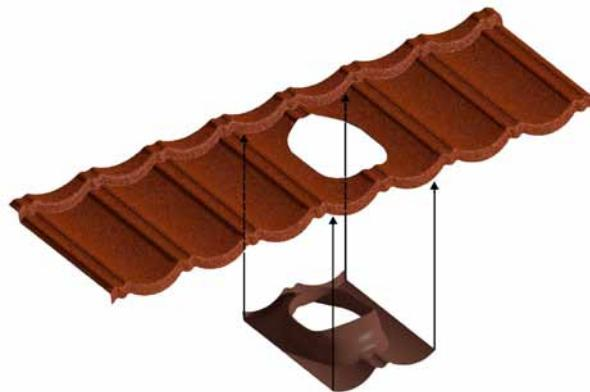
Рис. 37 а. Проходной элемент (DECRA) для панели Luxard Классик.
